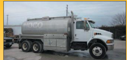
9052-Camion à eau Sterling 2002, modele Acterra, avec moteur CAT-3126, trans. 9 vitesses suspension pneumatique, avec citerne en aluminium de 16,000 litres, un compt. Inspecté.
