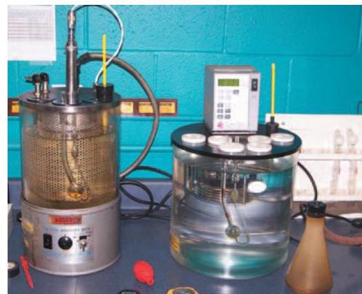
▲ Ce viscosimètre appartenant à l'usine Crevier Lubrifiants de Longueuil sert vérifier la viscosité de l'huile moteur à raison de deux bains par vérification, un à 40 degrés Celsius et un second à 100 degrés Celsius.
