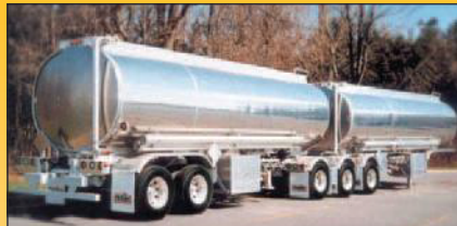
S700 – Remtec B-train 2013, 61 000 litres, 5 ou 6 compts. Intellicheck, récupération des vapeurs, charge par le bas et plus.
