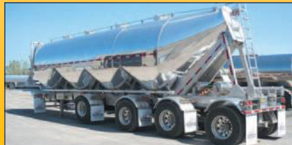
9130-2012 Tremcar pneumatique 1850 pi. cu., quatre chutes, déchargement sur ligne de 5', roues aluminium.
