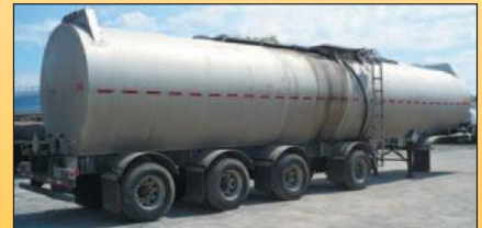
8853 – Advance 2002, 45,500 lts, en aluminium un compt, isolée pour produits chaud, serpentins pour chauffer, peut être convertie pour matières dangereuses. Inspectée.
