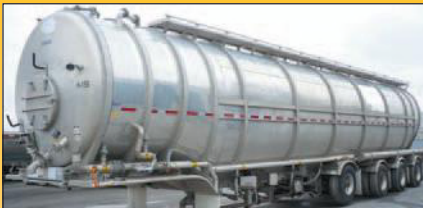
C248-2008 Tremcar 2800 pi.cu., citerne sous vide/ pneumatique, six chutes deux lignes de remplissages de 6", filtre à l'avant, déchargement de 4". Bas millage.
