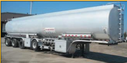
8986-2003 Remtec, 57 000 lts, pétroliers, cinq compartiments charge par le bas, recup. des vapeurs, inspectée B-620
