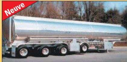
Remtec neuve 2013, 57 000 litres, (6) compt's. Récupération des vapeurs. Charge par le bas. Lumière «LED». Suspension pneumatique. Pneus Michelin.
