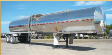
8826 – Tremcar 1999, 7200 USG, chimique en acier inox, DOT-407, un compt. isolée. Suspension pneumatique, inspectée.
