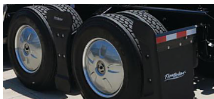
> L'ensemble aérodynamique pour tracteurs FlowBelow Tractor AeroKit
