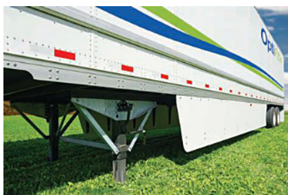
> Une semi-remorque munie de l'OptiFlow Wabco avec jupe latérale TrailerSkirt.
